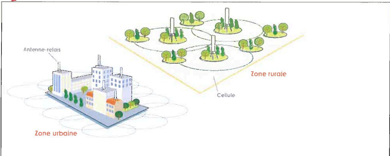
L'antenne-relais émet des ondes dans une direction privilégiée. Ce faisceau peut être comparé à celui d'un phare qui éclaire la mer. Les faisceaux principaux de l'antenne sont directifs et très fins (6 degrés environ) dans le plan vertical. L'intensité du faisceau diminue très rapidement (en fonction du carré de la distance) en s'éloignant de l'émetteur. Cf. schéma ci-dessous à titre indicatif.
